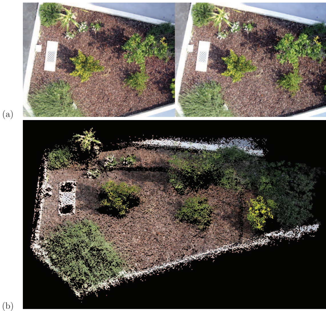
FIGURE 11 – Nouvelles acquisitions simultanées pour des applications de stéréorestitution. — (a) Couple stéréoscopique acquis à 7 mètres de hauteur du sol avec une taille d'échantillon au sol de 1,5 millimètres. ©ATIS — (b) Nuage de points 3D obtenu par B. Petitpas. La meilleure qualité des images augmente la capacité de l'algorithme à reconstruire un nuage dense. ©Université Paris-Est/TelecomParistech/Petitpas
