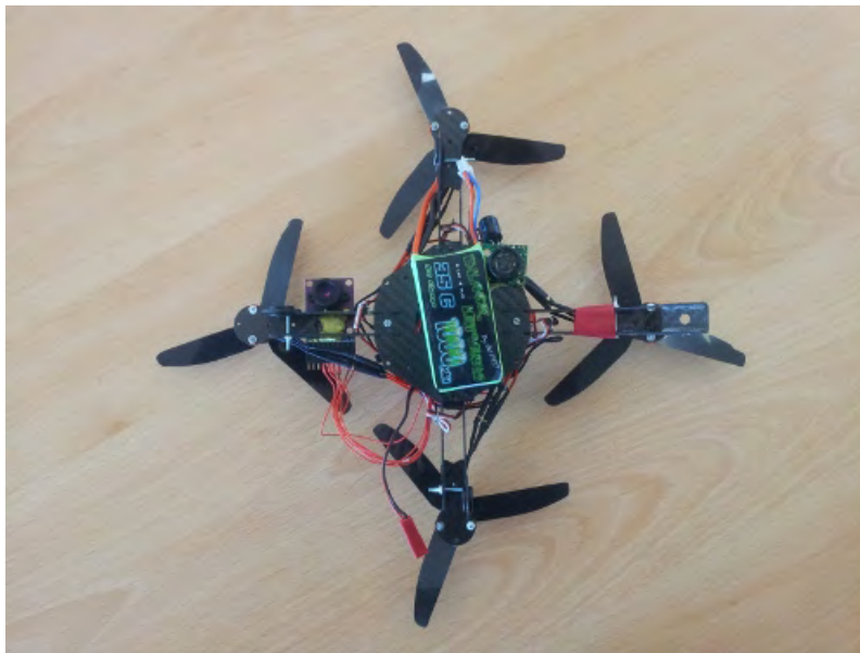
Figure 18 – Le micro-drone Sparrow vu du dessous dans sa version équipée du capteur ultra-son (à droite) et du capteur de flot optique bas niveau (à gauche).
