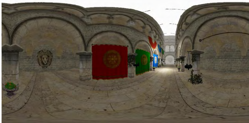
Figure 32 – Rendu temps réel d'un environnement virtuel avec un large champ visuel (360 degrés) grâce à une projection équirectangulaire (plate Carré)
