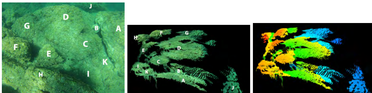
Figure 30 – Premiers résultats de la reconstruction 3D : l'image originale annotée (à gauche), la reconstruction 3D correspondante annotée et la carte de distance à la caméra (de rouge au plus près à bleu au plus loin).
